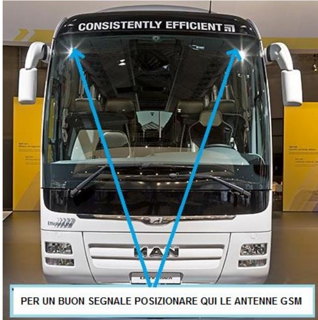
**Qualsiasi elettrauto è in grado di installare WiFiBus.** L'apparato si alimenta da 9 a 30v. ed è fornito di due antenne GSM interne con biadesivo da posizionare possibilmente nel punto più alto del parabrezza. Si consiglia di inserire sempre un interruttore con fusibile nel cruscotto.
